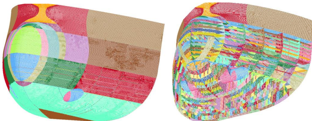
Figura 24 — Modelo numérico de FEM elaborado para porão/corpo paralelo do navio.
