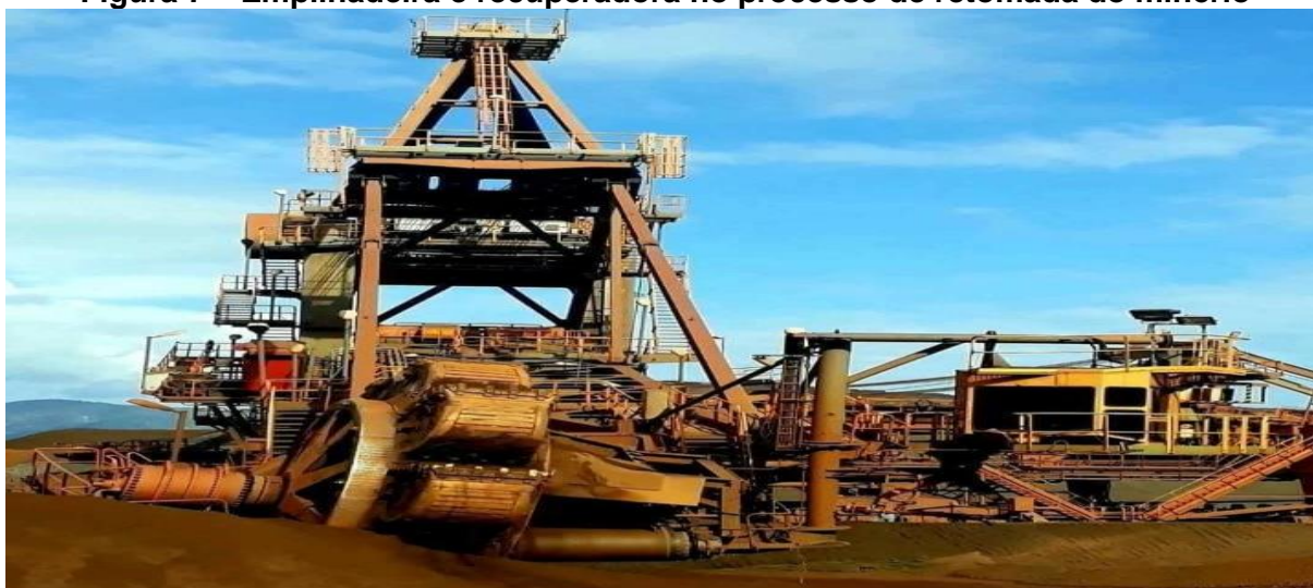
Figura 7 – Empilhadeira e recuperadora no processo de retomada do minério
