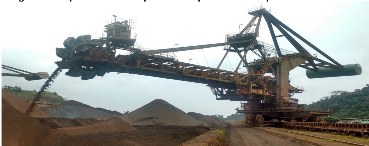
Figura 6 – Empilhadeira e Recuperadora no processo de empilhamento do minério
