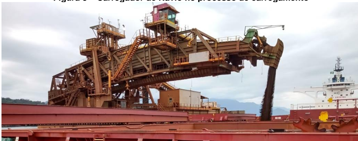
Figura 8 – Carregador de Navio no processo de carregamento
